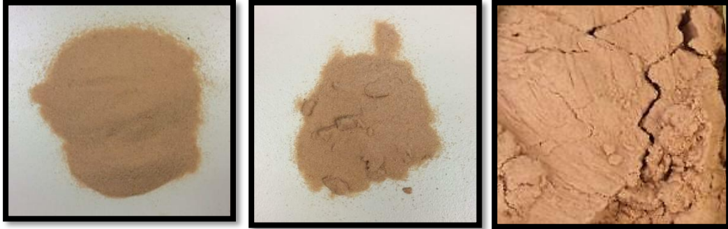
الشكل (11.3-ب) رمل رقم 1 رمل أحمر فاتح رطب (1300302)
