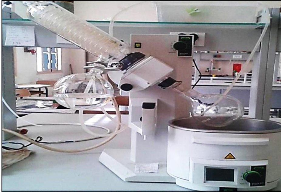
شكل 2.3. جهاز المبخر الدوار Rotary Vacuum Evaporator
